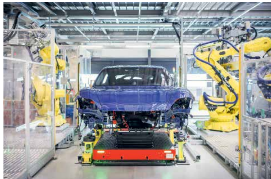
PORSCHE PRODUKTION 4.0: FAHRERLOSE TRANSPORTSYSTEME (FTS) IN DER TAYCAN-MONTAGE
