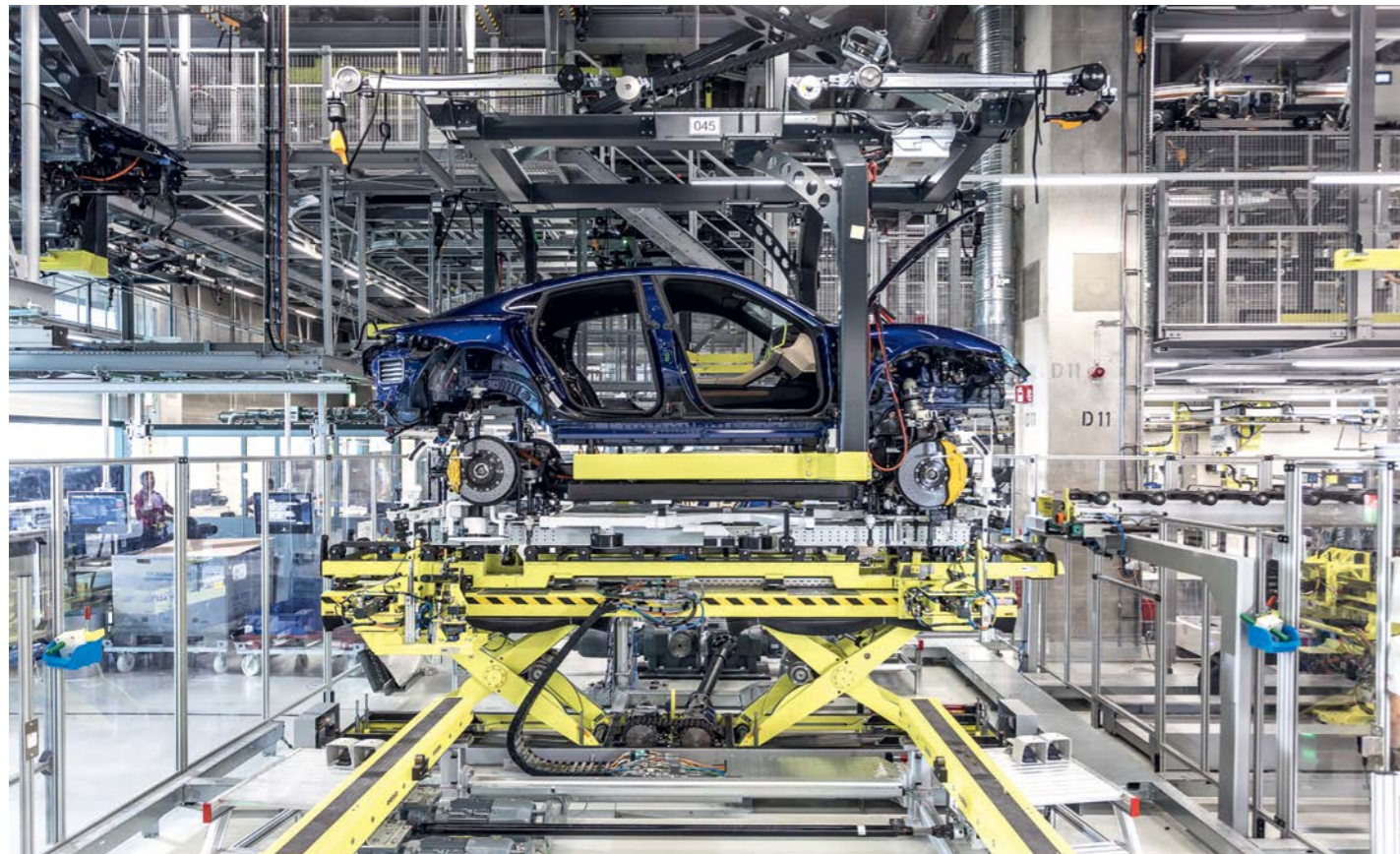
„HOCHZEIT“ IN DER TAYCAN-MONTAGE: E-ANTRIEB UND KAROSSERIE WERDEN MITEINANDER VERBUNDEN
